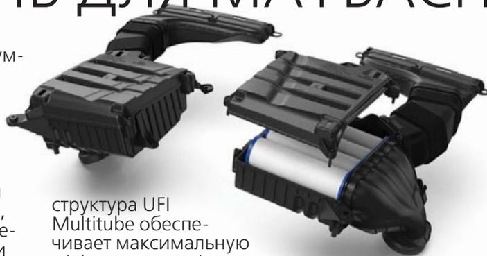
структура UFI Multitube обеспечивает максимальную эффективность фильтрации – более 99,5% – при гораздо меньших габаритах. Сам же фильтрующий материал из гидрофобных синтетических волокон FormulaUFI. Extreme характеризуется как огнестойкий и устойчивый к воздействию воды. Это важно, так как модуль будет располагаться в моторном отсеке в непосредственной близости от двигателя V12 мощностью 610 лошадиных сил.
