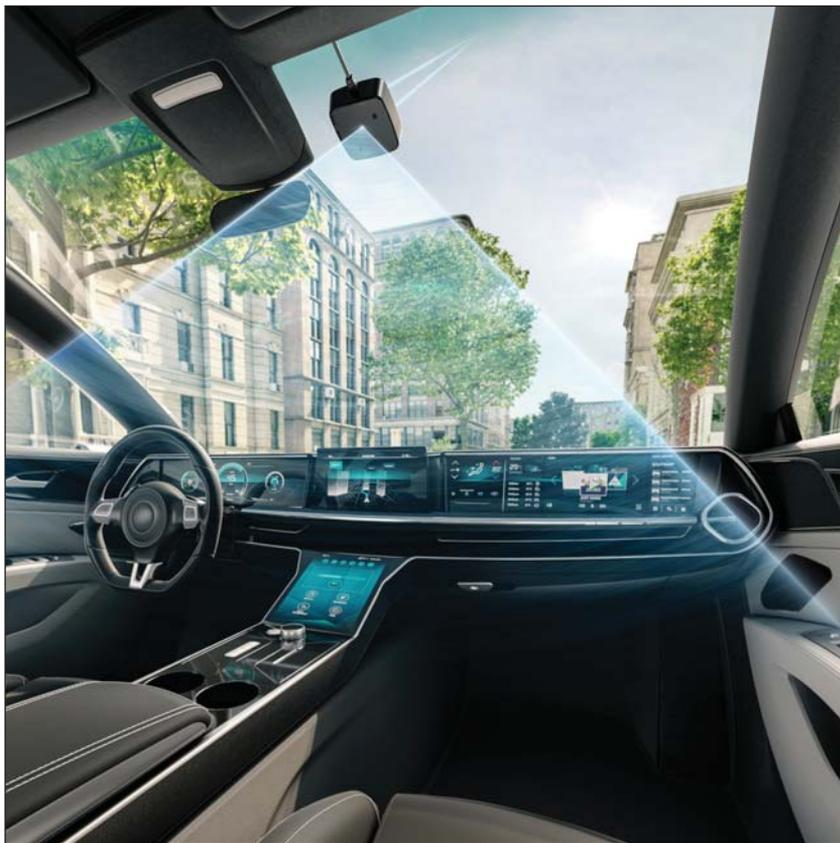
Компания Bosch разработала техническое решение, помогающее поддерживать безупречное состояние автомобилей, использующихся в каршеринге. Блок датчиков помогает обнаруживать повреждения и задымление внутри машины, данные анализирует искусственный интеллект.
