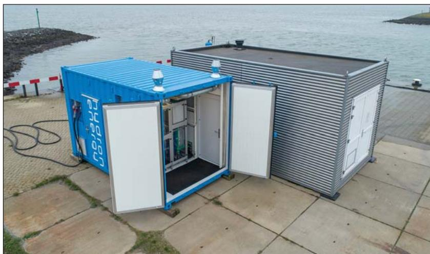
На сегодня консорциум уже убедился в функциональности своей системы очистки воды, проверив ее на испытательной установке, работающей на голландском острове Тексель в Северном море. Команда Hydron, которая входит в Schaeffler, работает над масштабированием установки опресне-
