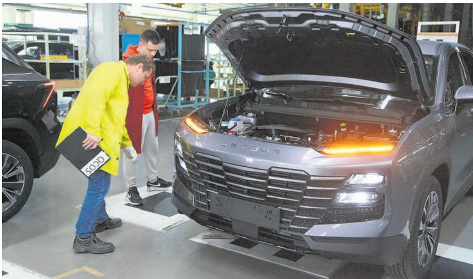
Контролеры управления технического контроля выискивали намеренно допущенные дефекты на готовых автомобилях и составляли акты о браке.
