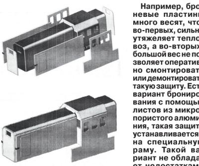
Например, броневые пластины много весят, что, во-первых, сильно утяжеляет тепловоз, а во-вторых, большой вес не позволяет оперативно смонтировать или демонтировать такую защиту. Есть вариант бронирования с помощью листов из микропористого алюминия, такая защита устанавливается на специальную раму. Такой вариант не обладает недостатками предыдущего, но у него есть свой — рама, которая должна быть предварительно смонтирована и закреплена на тепловозе.
