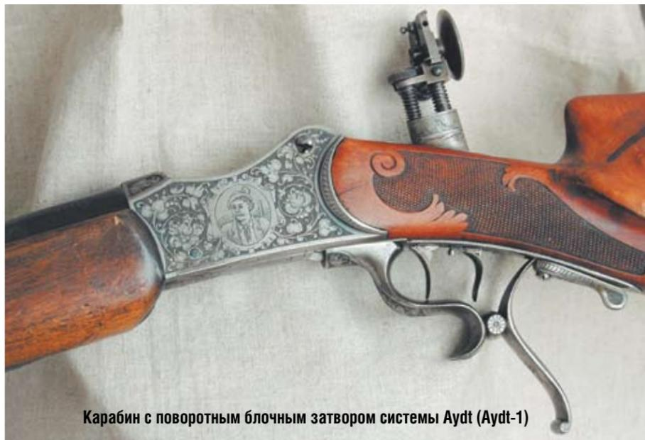
Карабин с поворотным блочным затвором системы Auydt (Auydt-1)
